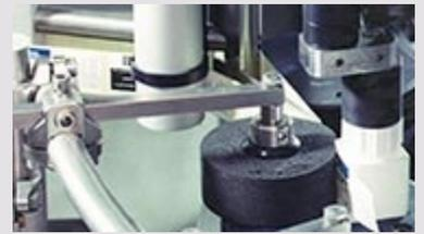
Machines d'étiquetage avec des collecteurs tournants qui permettent de transférer la puissance, les signaux et bus de terrain à haut débit de données
