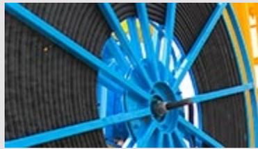
Au travers d'enrouleurs, sont transmis des signaux et de la puissance électrique ainsi que des données grâce aux collecteurs tournants...
